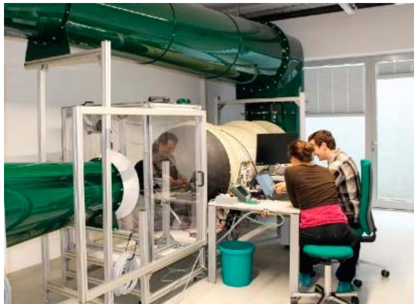
Blick in das Labor für die Messgröße Strömungsgeschwindigkeit mit dem neuen Strömungskanal. Der Kalibrierumfang beinhaltet jeweils die Sichtprüfung/Reinigung, eine Überprüfung aller Bedienelemente und Funktionen, die Erstellung eines zweisprachigen Kalibrierzertifikates mit Soll-/Istwert, Abweichung, Messunsicherheit, Kalibriermarke und Kalibriernummer
