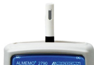
ALMEMO® 2790 mit Fühler für Feuchte, Temperatur, Luftdruck Option OA 2790-RHA
