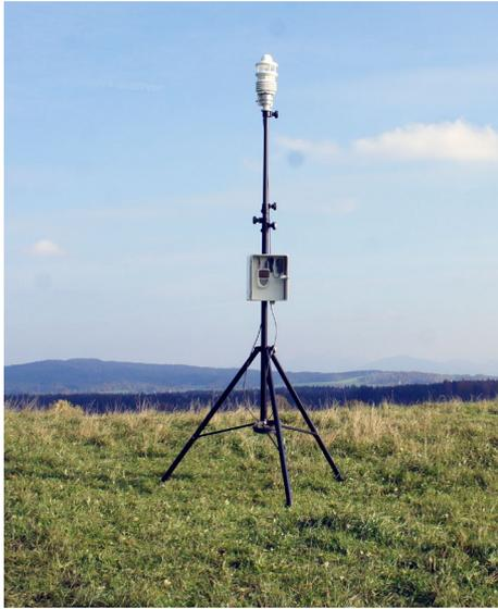
Professionelle Wetterstation für mobilen Einsatz zur Messung aller relevanten meteorologischen Größen. Leicht zu installieren, robuste Ausführung, unterschiedliche ALMEMO® V7 Datenlogger möglich.
