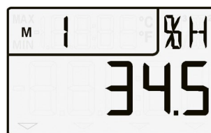
Messwertanzeige Kanal M1 Feucht- tegröße, z.B. relative Feuchte
