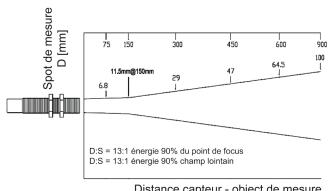
Distance capteur - object de mesure S [mm]
