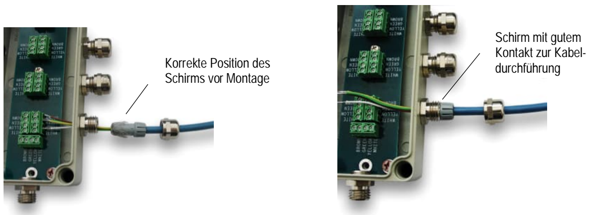
Abbildung 52: Korrekte Montage des Kabelschirms
