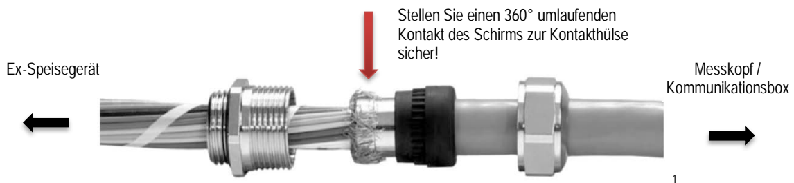
Abbildung 46: EMV gerechter Anschluss eines Kabels für Messköpfe und Kommunikationsbox
