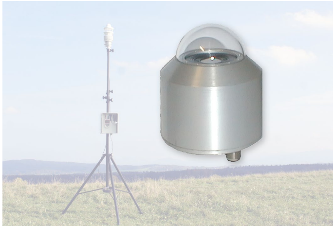
ALMEMO® UVE-Messkopf im wettergeschützten Gehäuse für Ausseneinsatz, FLD7 33-UVE
