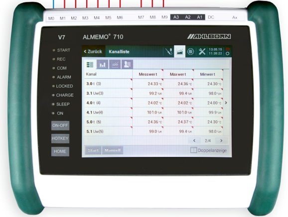
Die Messorte 0...9 entsprechen der Positionierung der ALMEMO® Messfühler im Messraum einer Klimakammer
