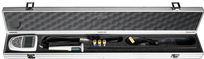
Capteur de température à résistance de précision Pt100 FPA924L0500H en valise. (Le dispositif de mesure et les accessoires ne sont pas inclus dans la livraison)
