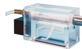
Plage d'utilisation : 0 (pas de glace) à 90 °C, 10 à 100 % h.r. capteur numérique de pression d'air intégré : 700 à 1100 mbar. Le psychromètre se place au centre du volume utile. D'après les valeurs de mesure température sèche  $t$  et température humide  $t_w$ , associées à la pression atmosphérique  $p$  (capteur de pression atmosphérique intégré dans l'connecteur ALMEMO®), l'humidité relative  $U_w$  est déterminée au centre et le point de rosée  $t_d$ .
